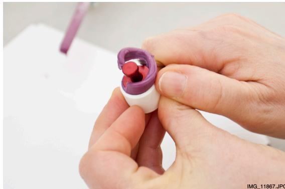
5. Saque suavemente el pin de calibración y asegúrese de que las superficies del orificio formado por el pin de calibración sean regulares (que no haya burbujas de aire dentro de las paredes).
