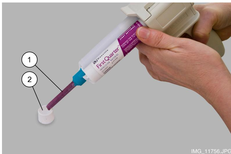
2. Coloque el pin de calibración suministrado (número de pieza 10031265) en el material.
